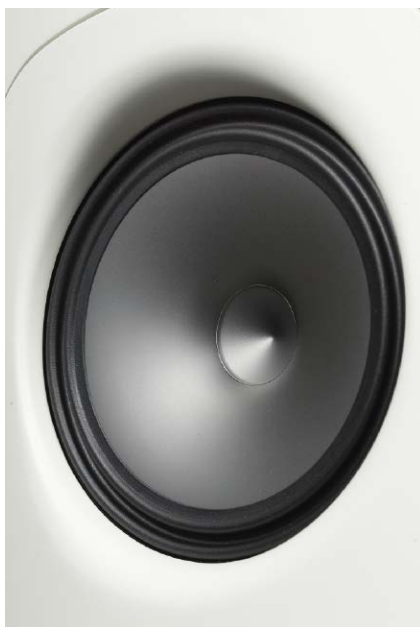
Membrana średniotonowa ma szczególnie profil, z którym wiąże się jej sztywność i oczekiwane charakterystyki.
